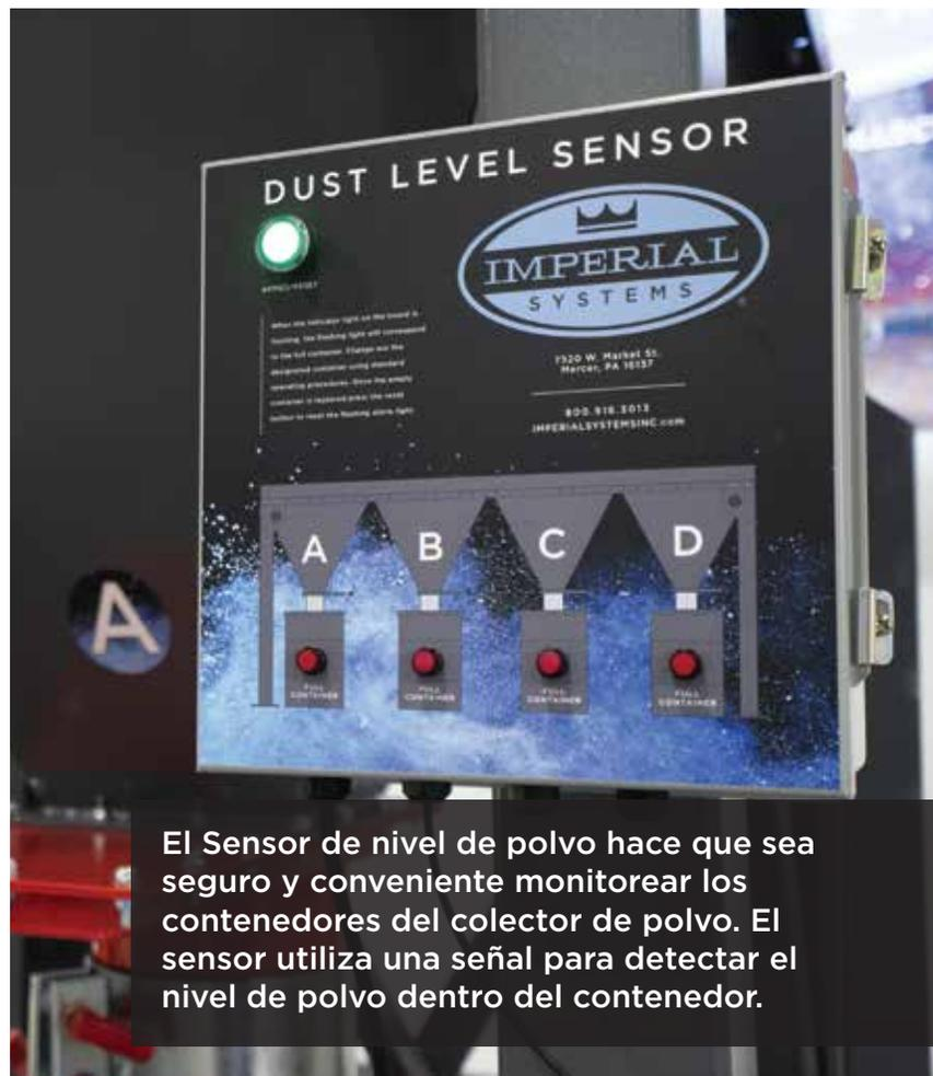
El Sensor de nivel de polvo hace que sea seguro y conveniente monitorear los contenedores del colector de polvo. El sensor utiliza una señal para detectar el nivel de polvo dentro del contenedor.
